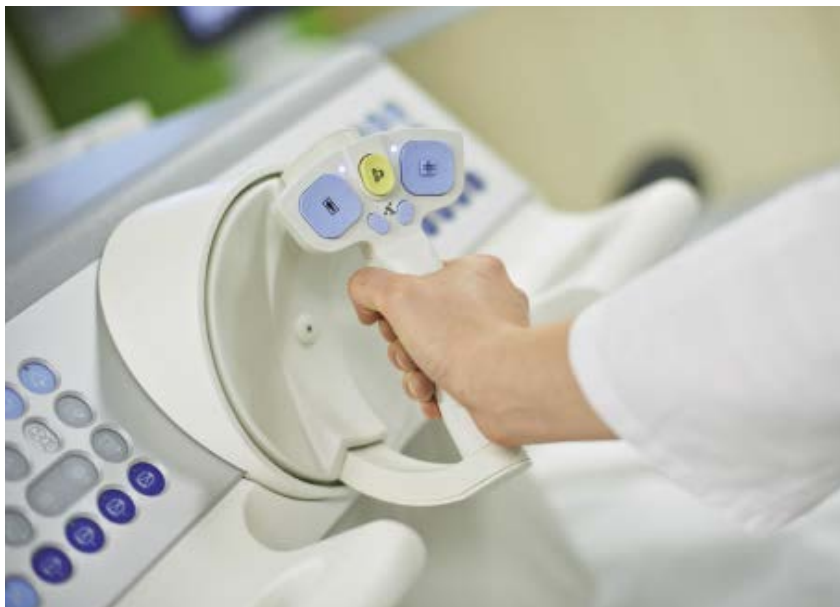
Позиционирование упрощается благодаря возможности управления ключевыми функциями одной рукой и полной моторизации перемещения стойки.
