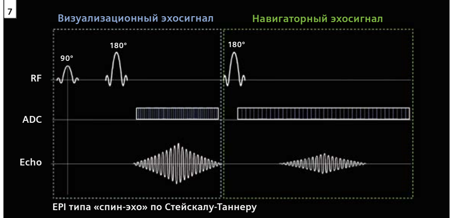
7 Упрощенная импульсная диаграмма последовательности RESOLVE (градиенты не показаны).
