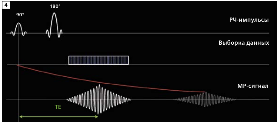
4 Преимущества снижения времени выборки: (I) уменьшение искажений из-за восприимчивости (меньшее накопление фазовой погрешности); (II) уменьшение T_2^* -нерезкости (ускорение выборки); (III) возможность использовать меньший интервал TE (в связи с более быстрым заполнением k -пространства, что в свою очередь подводит центр окна считывания ближе к импульсу 180^\circ ).
